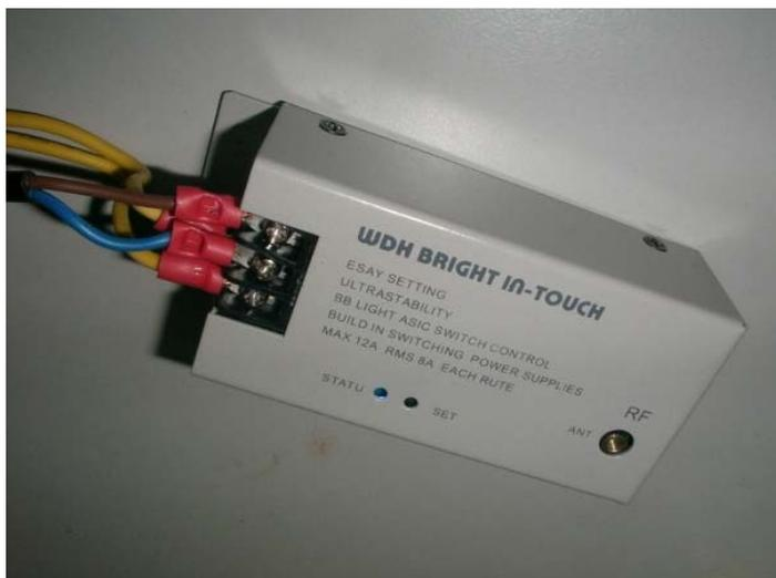
圖四 PA08 與電力線連結配置
